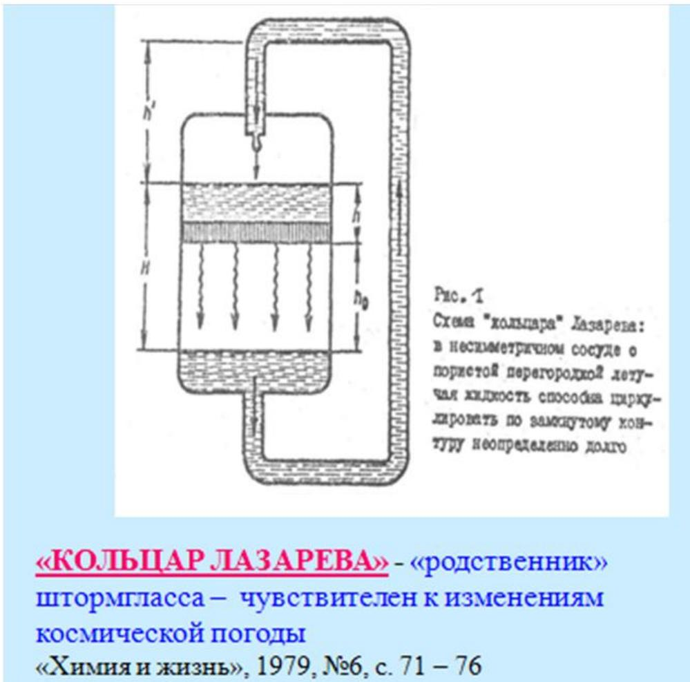
**Рис. 13** Схема «кольцара Лазарева». Вода неопределенно долго циркулирует в замкнутом сосуде. Вероятный аналог штормгласса. В нем под влиянием внешних воздействий изменяется растворимость, в кольцаре – вязкость. Рисунок взят из работы В. Е. Жвирблиса, цитируемой в тексте.
