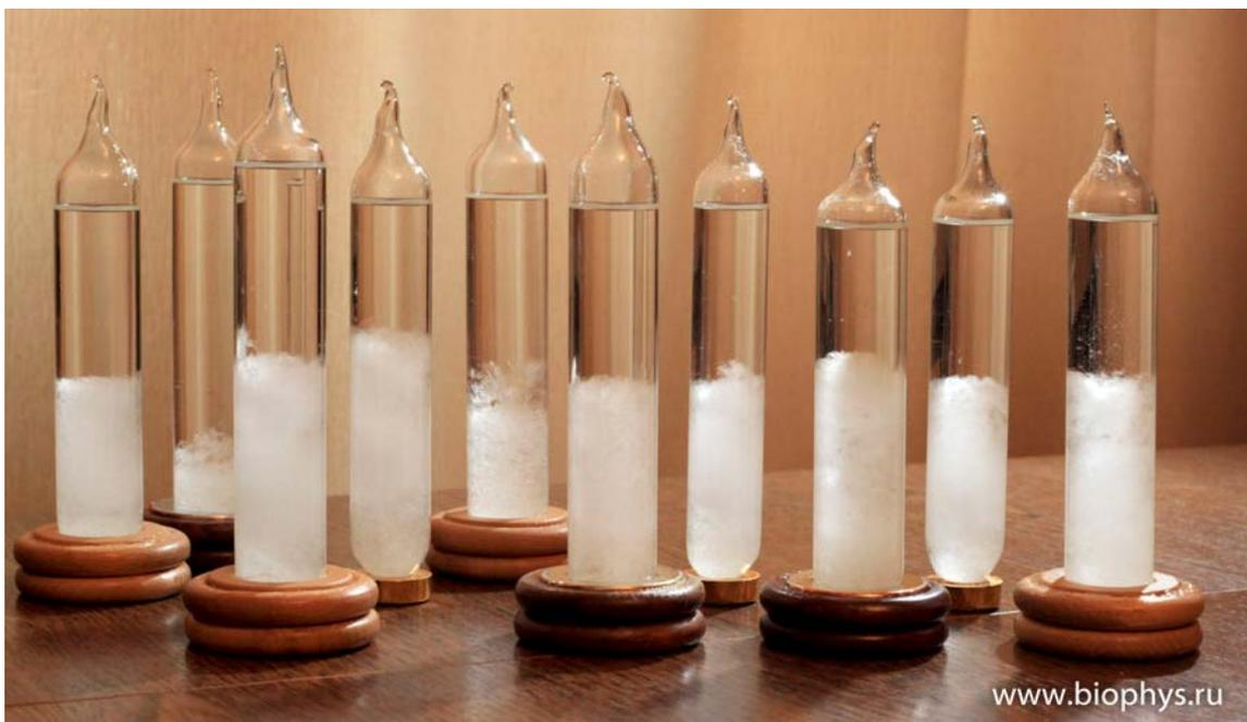
**Рис. 1** Общий вид штормгласса – колбы Фицроя.
