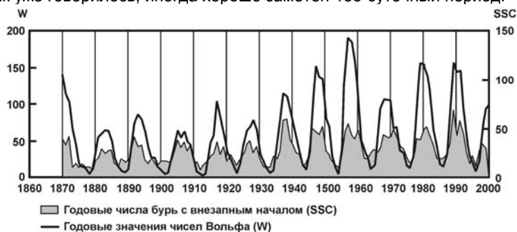
Рис. 4.1. Динамика следования бурь с внезапным началом (SSC) в 11-летнем цикле солнечной активности (W).
